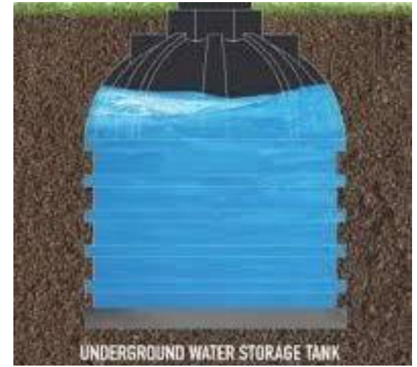
पीव्हीसी किंवा प्लास्टिक टाकी- जमिनीखालील
